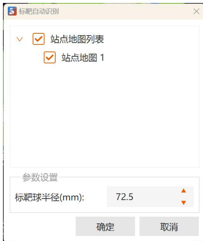
图 2-54 靶球自动识别设置靶球半径
