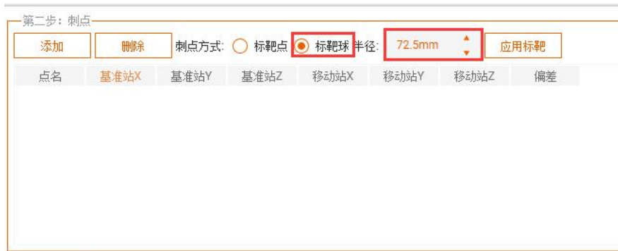
图 2-39 选择刺点方式（注：标准靶球半径为 72.5mm）
