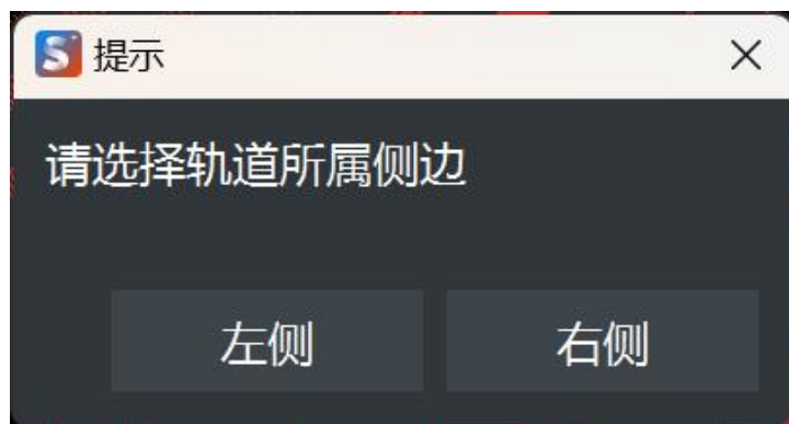
图 3-27 选择所属侧边（注意选取所属侧边左侧和右侧是根据选取轨道方向确定）
