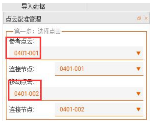
图 2.3- 4 选取对应参考点云和移动点云
